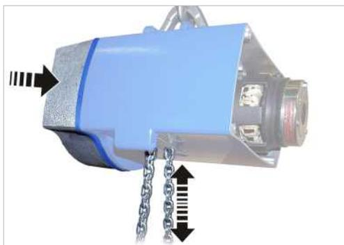
→ Inserire il riduttore nella carcassa. Tirare leggermente la catena finché l'albero di trasmissione del riduttore non si innesta nella noce di carico.
