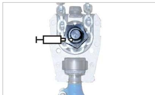
Lubrificazione sul posto/in fabbrica con "Klüber Staburags NBU 12 Alltemp", codice articolo ABUS 14980.
